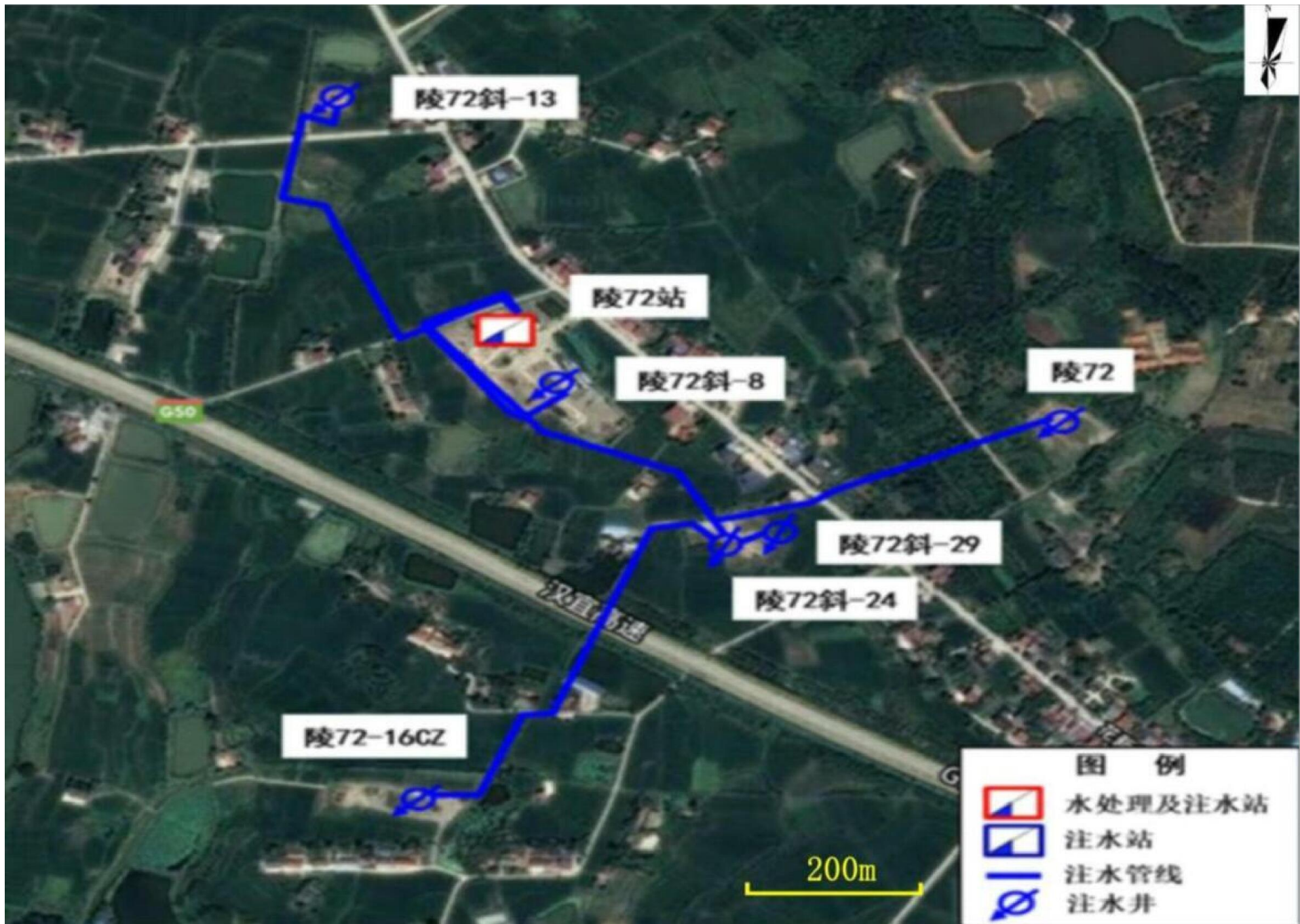
附图 5-2 陵 72 站周边注水管网图
