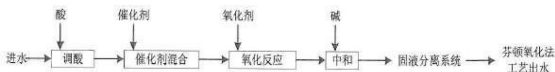
图 5-2 芬顿氧化法废水处理工程工艺流程图
