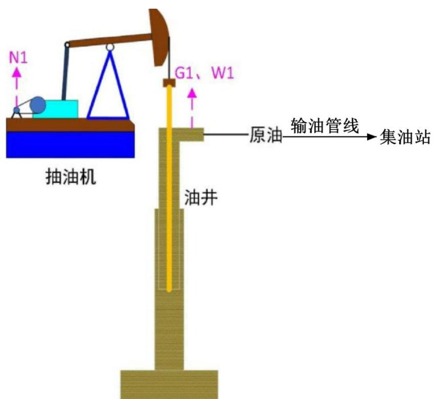
图 2-4 原油开采工艺流程及产污节点图
