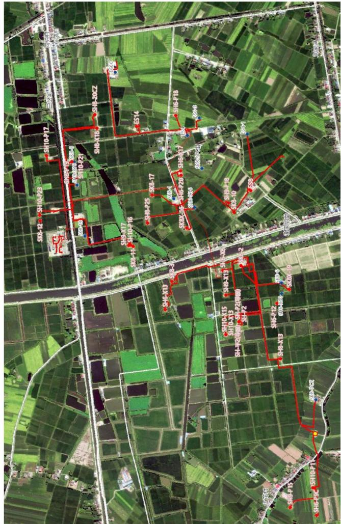
附图 5-2 同心集油站周边输油管线图
