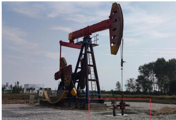
图 4-2 采油点处围堰，地面已铺石子硬化
